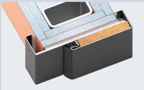
3. Vissage du profilé de contre-habillage avec le profilé à travers la rainure d'étanchéité, puis recouvrement avec le joint de porte
